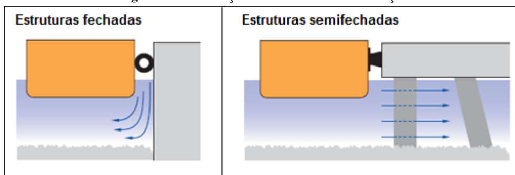
Figura 37 – Ilustração do coeficiente de atracação
