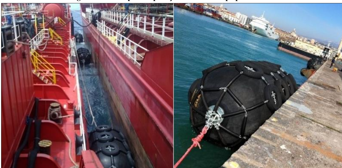
Figura 45 – Exemplo de aplicação de defensas tipo pneumáticas
