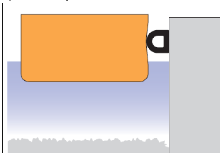
Figura 36 – Definição do coeficiente de amortecimento do casco
