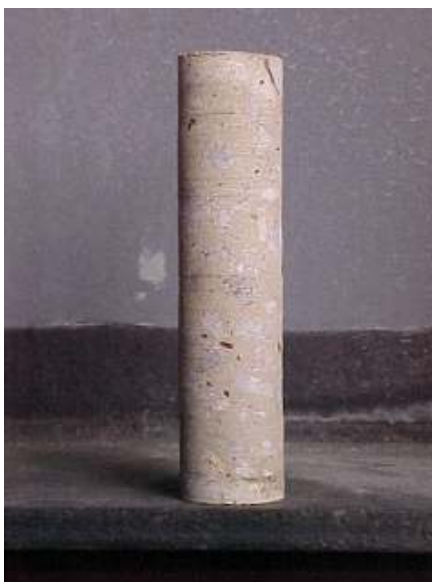
FIGURA 3.15 – Testemunho de concreto da parede
