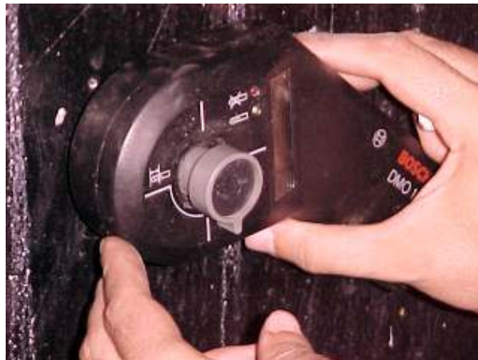
FIGURA 3.13 – Pacômetro utilizado antes da extração de testemunhos.
