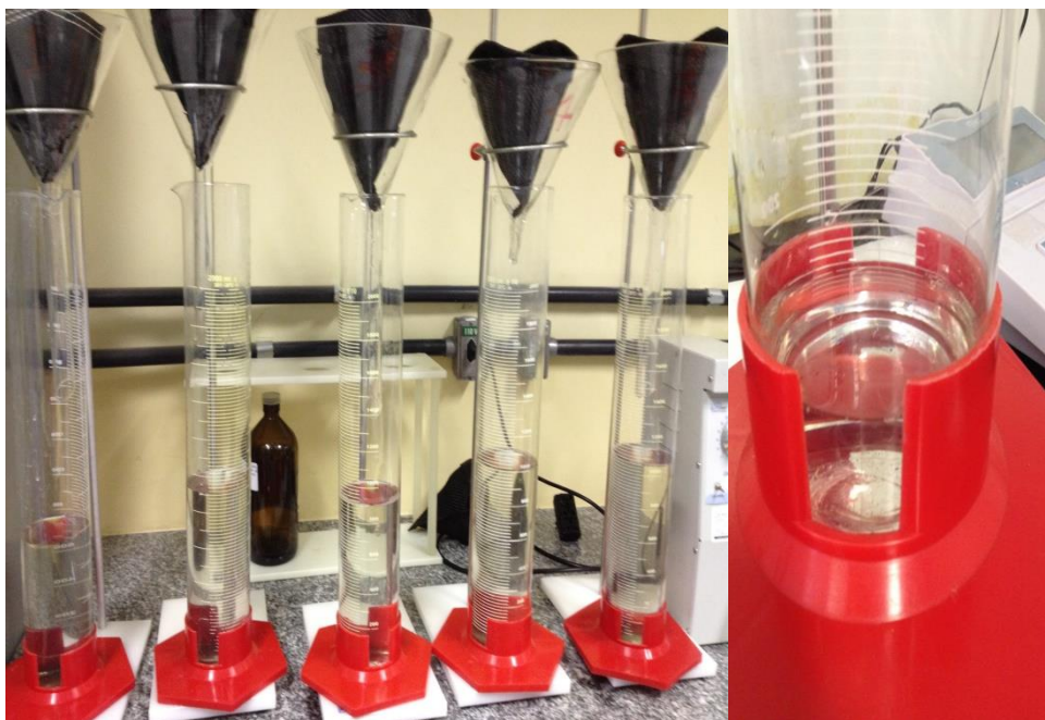
Figura 13: Ensaio preliminar de desidratação do lodo e coleta do filtrado.
