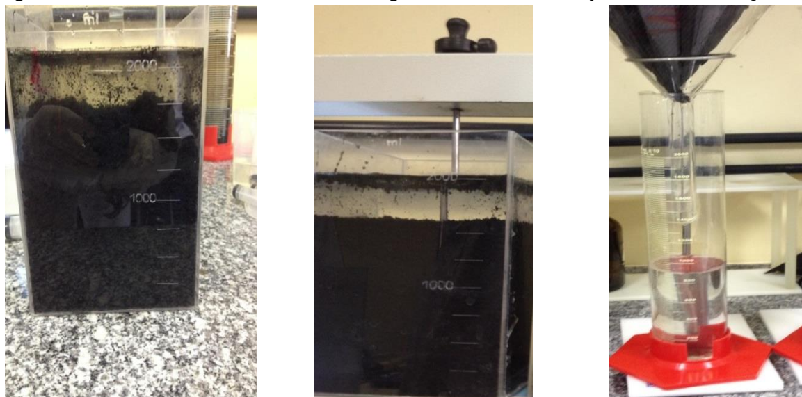
Figura 18: Qualidade dos flocos formados no segundo teste com a obtenção do filtrado 2 na proveta.
