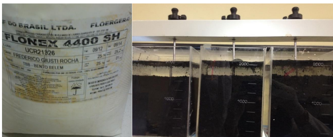
Figura 12: Condicionamento e homogeneização do lodo com PAC e polímero nas cubas de acrílico de 2 L do Jar test.
