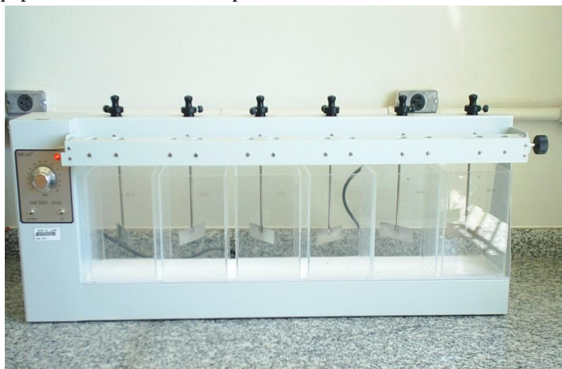
Figura 6: Equipamento Jar test utilizado para o condicionamento do lodo da ETE Vila da Barca.
