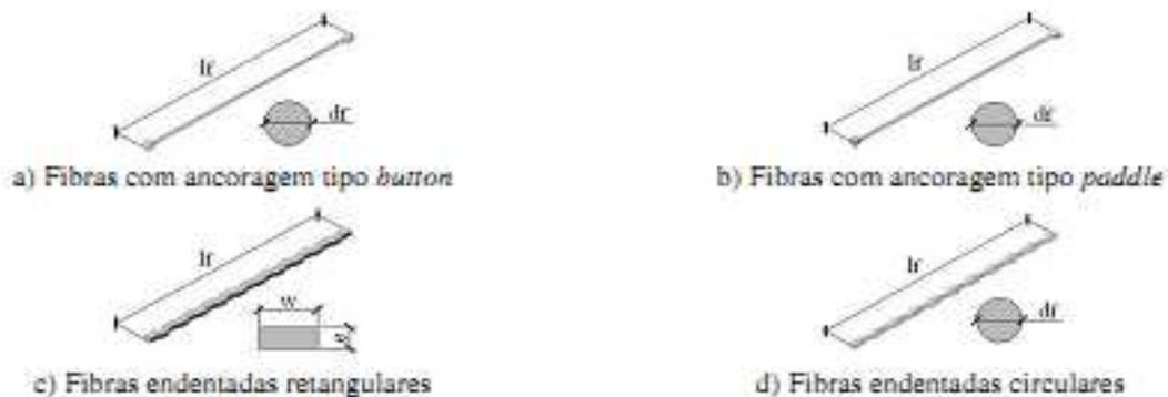
Figura 4.10 - Outros tipos de fibras apresentados pelo Technical Report nº 63 (The Concrete Society)
